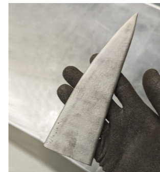
Im Auftragschweißverfahren gedruckte Zinke für das Minenräumgerät
